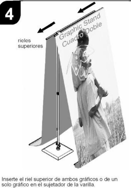
4 Inserte el riel superior de ambos gráficos o de un solo gráfico en el sujetador de la varilla.
